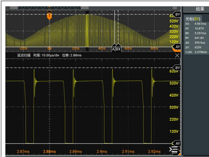
1#: V_{in}=300Vac, DC=24V 2.5A, V_{DS} \approx 625V
