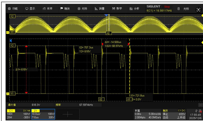
1#: Vin=300Vac,DC=24V 1.5A,V DS ≈618V
